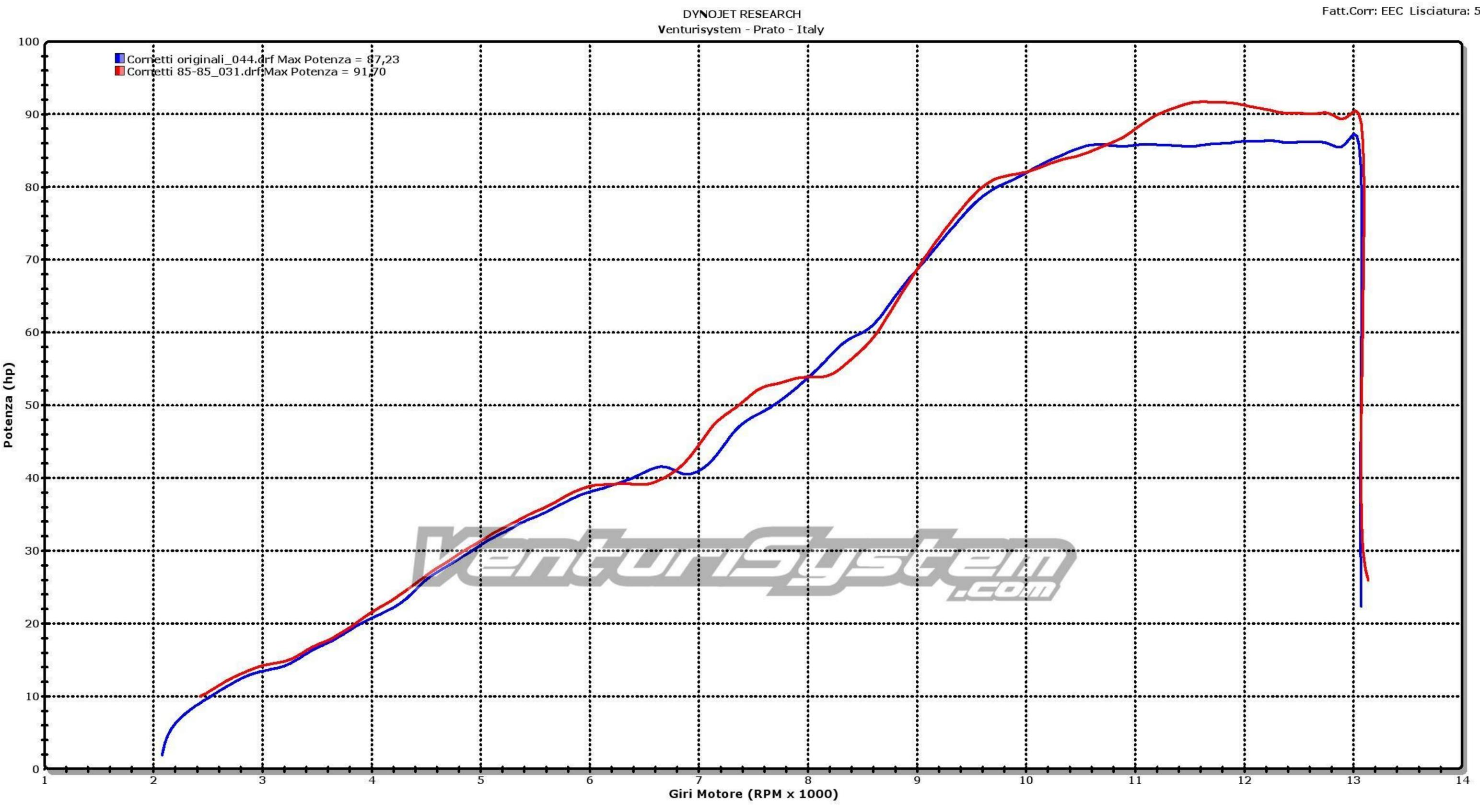
Cornetti originali\_044.drf - 13/11/2010 20:34:06 Tipo Test: RO Run Conditions: 11,90 ℃, 1022,55 mBar, Umidità: 41%, EEC: 0,94 Suzuki GSR 600 2007
